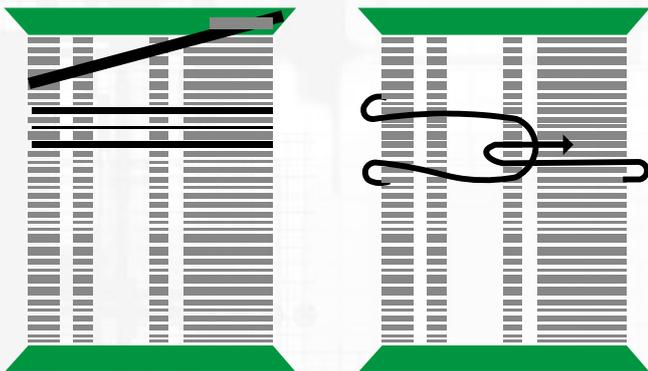
Für eine ordnungsgemäße Einlagerung teilweise verbrauchter Spulen empfehlen wir das freie Ende des Erodierdrahtes nach Gebrauch am Spulenflansch oder durch eine Drahtschleife zu befestigen (siehe Abbildungen).
